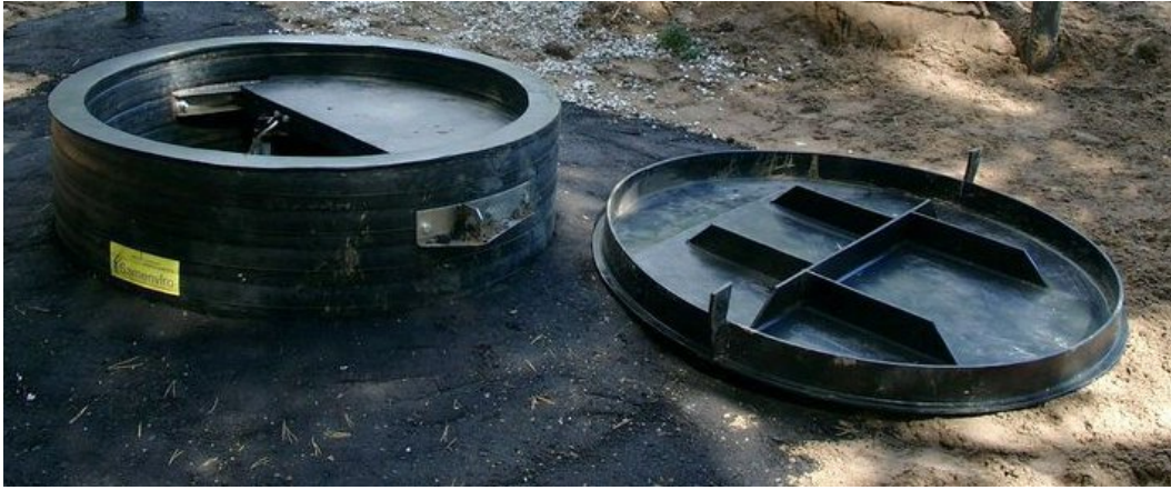
Рис. 39. Вид испытанной КНС в сейсмоизолирующей оболочке (обойме) из пеностекла с полипропиленовой (пенотерм) «плавающей» прослойкой
