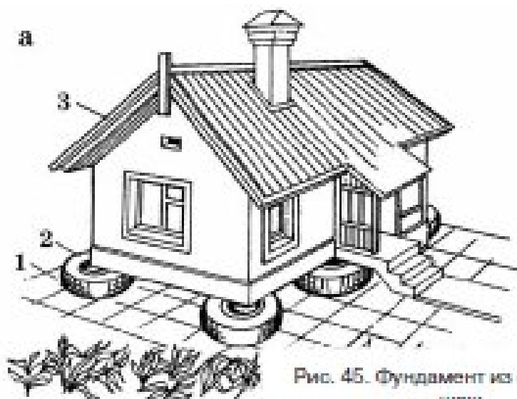
а — общий вид дома: 1 — плита основания; 2 — автопокрышка; 3 — жилой дом; б — конструкция фундамента: 1 — утрамбованный грунт основания; 2 — автопокрышка; 3 — бетонная плита основания; 4 — песок; 5 — гравий.
